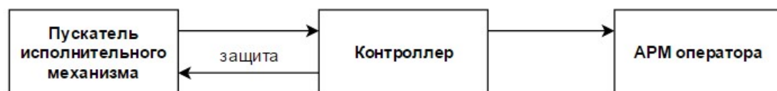
Рисунок 5: Схема прохождения сигналов в системе аварийной защиты
