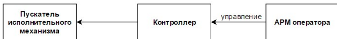
Рисунок 3: Схема управления дискретным сигналом
